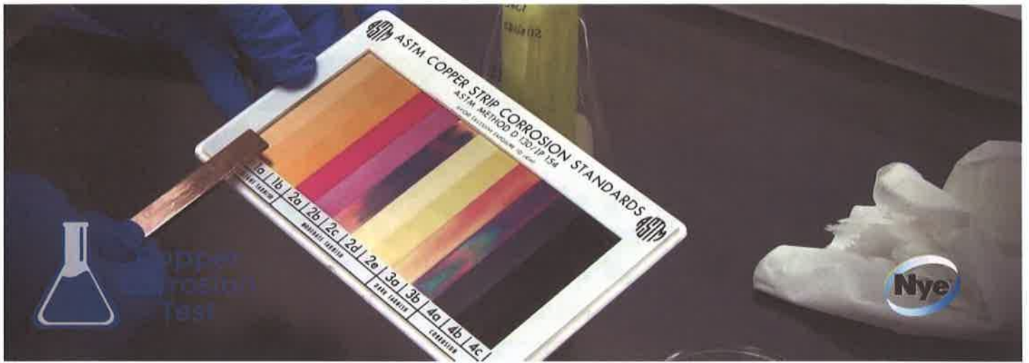
銅片侵蝕標準表（用於檢測油品中的硫含量）（Nye Lubricants, Inc.提供）
